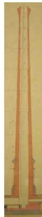
Des briques trapézoïdales pour épouser la courbure des conduits
